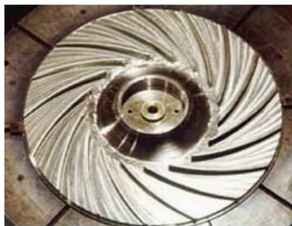
1.13 Сурет – Ортадан тепкіш компрессордың жабық және 2D профильді жұмысшы дөңгелегі
