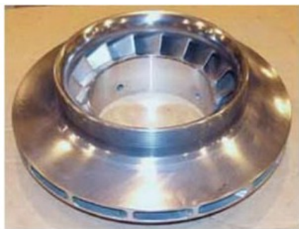
1.13 Сурет – Ортадан тепкіш компрессордың жабық және 2D профильді жұмысшы дөңгелегі
