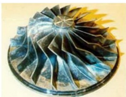
1.14 Сурет – Ортадан тепкіш компрессордың ашық және 3D профильді жұмысшы дөңгелегі
